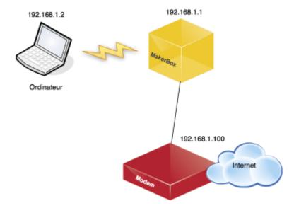
Figure 3. Schéma complet du réseau connecté à Internet
